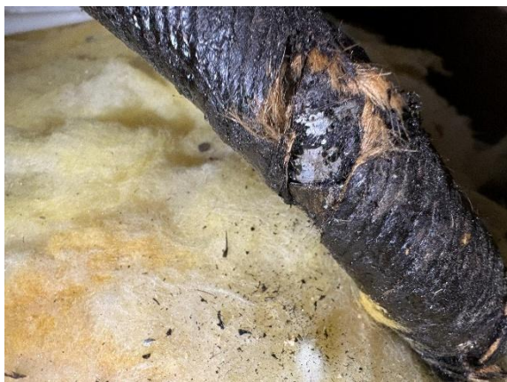
Bilde 10: Kabel på loftet, prøve A5
